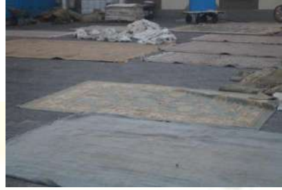
Fotoğraf 13. Beyazlatılmış halıların kurutma işlemi (Kılıç Karatay,2016)
