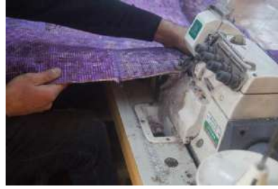
Fotoğraf 10. Ovarlak makinesi (Kılıç Karatay,2016)
