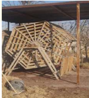
Fotoğraf 8. Toz Çırpma makinesi (Kılıç Karatay,2016)
